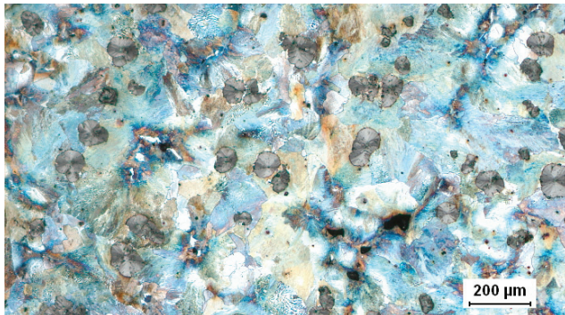
Feritisch-perlitisches Gusseisen mit Kugelgraphit
